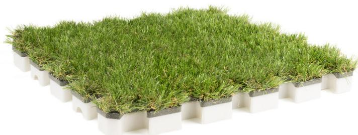
Fornitura di pavimentazione tipo “Roofingreen M10”, drenante, in appoggio continuo idonea per superfici permeabili anche lievemente cedevoli (Sp. totale 40 mm), costituito da strato in erba sintetica H 35 mm (filo primario monofilo bicolore in PE 9300 DTEX e filo secondario arricciato bicolore in PP 6000 DTEX, 9375 punti/mq, Resistenza UV Blu > 7 - Grigi < 4), strato isolante in XPE sp= 10 mm (R = 0,766 (m2K)/W, densità 50kg/mc), base in polipropilene. Confezioni da 5,5 mq.
