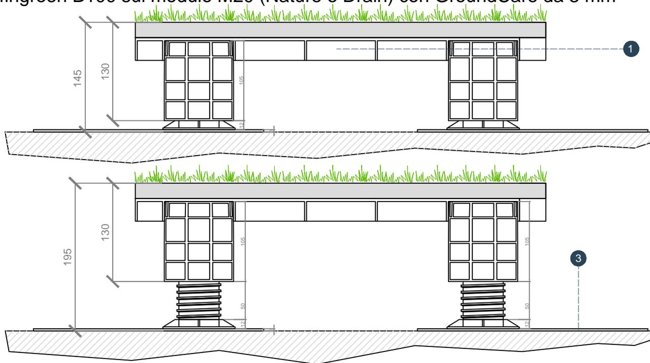
Roofinggreen B50 sul modulo M20 (Nature e Drain) con GroundCare da 5 mm
