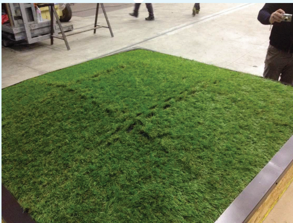
Particolare del campione durante la prova a -3000 Pa.
