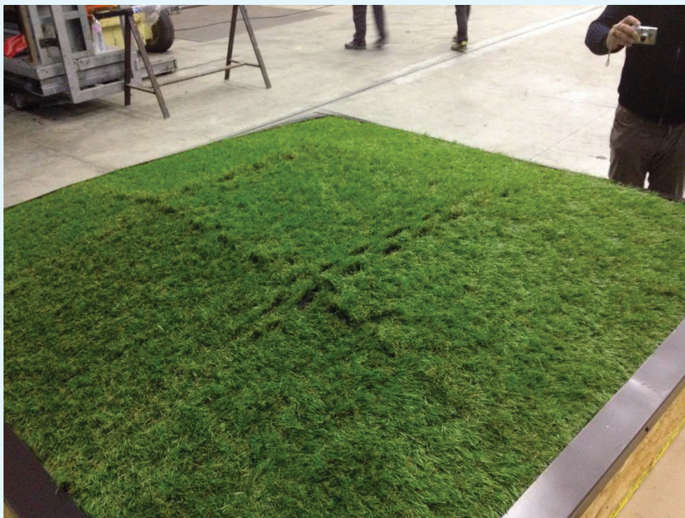
Particolare del campione durante la prova a -2600 Pa.
