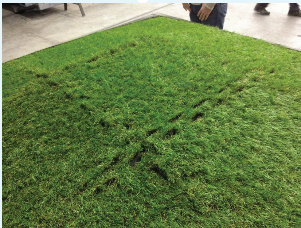
Particolare del campione durante la prova a -2000 Pa.
