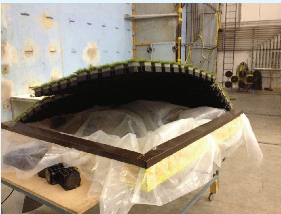
Particolare del campione dopo il collasso a -3200 Pa.
